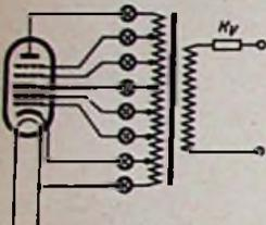
Bild 1. Elektrodenschluß-Prüfschaltung für gleichzeitige Anzeige aller etwa vorhandener Elektrodenschlüsse
