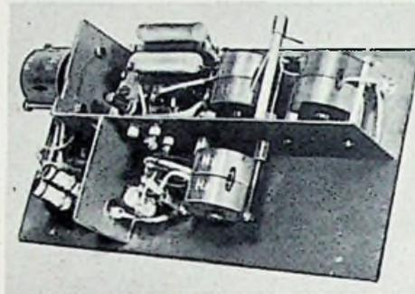
Bild 7. Abschirmkammern und Verdrahtung des Generatorteils
