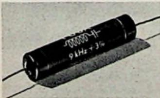
quenzgenauigkeit +3%, Betriebs-spannung 500 V, Prüfspannung 1500 V. Die Spule konnte mit Hilfe eines Ferritkernes sehr klein gehalten werden. Form und Maße entsprechen denen eines Rollblockkondensators; wie dieser kann die 9-kHz-Sperre unmittelbar in die Verdrahtung eingelötet werden. Hersteller: Fuba Hans Kolbe & Co., Hildesheim.
