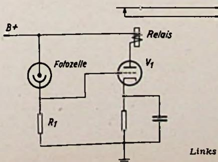
Links: Bild 1. Prinzipschialtung eines Fotozellenrelais
