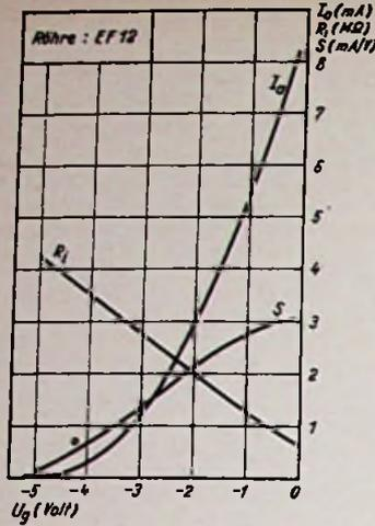
Bild 5. Verhalten der Röhrenkennwerte im  $J_e U_p$ -Kennlinienfeld einer Pentode (aus Kunze, Röhren-Dokumente, Franzis-Verlag, München 22)
