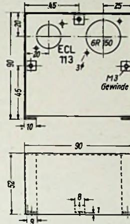
Bild 11. Chassis und Einzel- teilanordnung des Nf-Ver- stärker- teils
