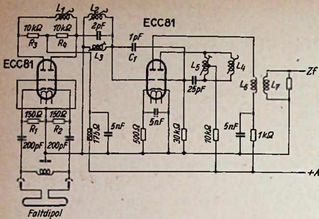
Bild 5. Grundig-FS-Empfänger mit Gitterbasts-Gegentakt-Vorstufe (ohne Umschaltung auf die FS-Kanäle).
