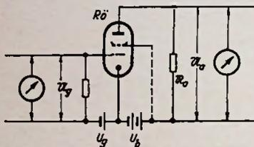
Bild 6. Prinzipielle Schaltung einer Verstärkerstufe mit Einzelzeichnung der meßbaren Wechselspannungen durch Röhrenvoltmeter
