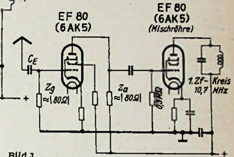
Bild 3. Ersatzschaltbild zu Bild 2 für Störfrequenzen
