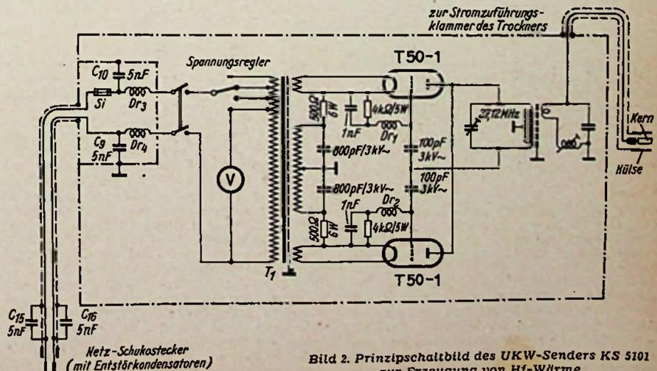
Bild 2. Prinzipschaltbild des UKW-Senders KS 5101 zur Erzeugung von Hf-Wärme
