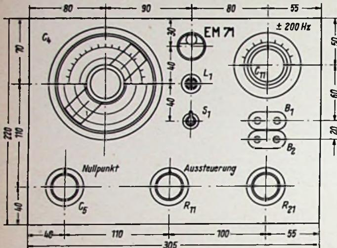
Bild 3. Einzelteileanordnung und Maßskizze für die Gesamtf frontplatte
