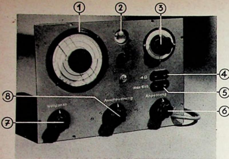
Bild 14. Frontansicht des Schwebungssummers. 1 = Hauptskala, 2 = Magischer Fächer EM 71, 3 = Feinskala für tiefe Frequenzen, 4 = niederohmiger Ausgang, 5 = hochohmiger Ausgang (max. 10 k $\Omega$ ), 6 = Regler für hochohmigen Ausgang, 7 = Nullpunktregler für Hauptskala, 8 = Aussteuerungsregler (Ausgangsspannung)
