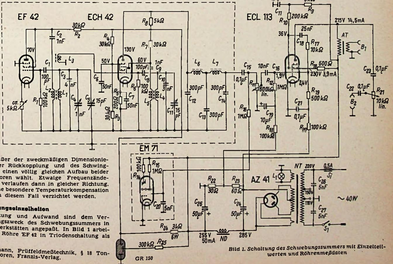
man außer der zweckmäßigen Dimensionierung der Rückkopplung und des Schwingkreises einen völlig gleichen Aufbau beider Oszillatoren wählt. Etwaige Frequenzänderungen verlaufen dann in gleicher Richtung. Auf eine besondere Temperaturkompensation kann in diesem Fall verzichtet werden.
