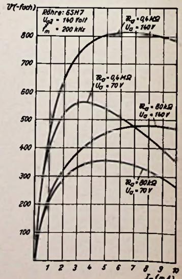
Rechts: Bild 10. Verlauf des Verstärkungsgrades bei einer Hf-Pentode, bei der der Außenwiderstand durch einen Abstimmkreis mit unterschiedlichem Resonanzwiderstand gebildet wird
