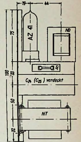
Bild 12. Maßskizze für die Netzteil-Baueinheit
