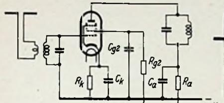
Bild 1. Schaltbild einer Hf-Verstärkerstufe mit kapazitiv überbrücktem Katoden-, Schirmgitter- und Anodenwiderstand
