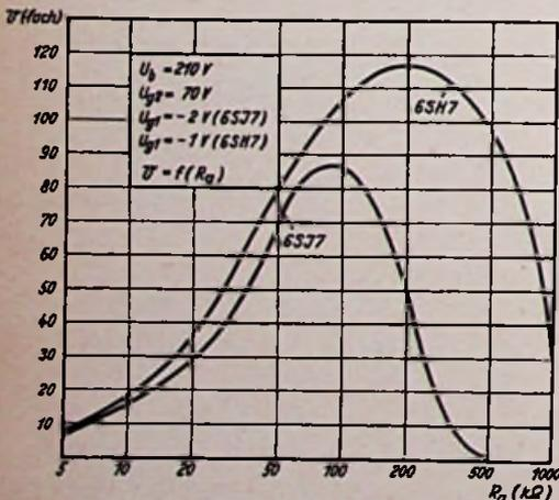
Bild 8. Die Verstärkung von Trioden mit verschiedenem hohem Durchgriff in Abhängigkeit vom ohmschen Außenwiderstand bei Widerstandskopplung
