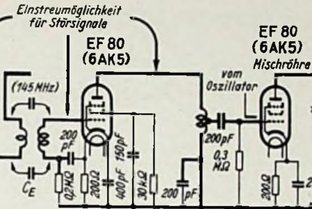
Bild 2. UKW-Vorverstärkerteil eines 2-m-Amateur-supers. Die verstärkt gezeichneten Leitungen und Schaltelemente sind aufnahmefähig für Zf-Störsignale. Die Katode der EF 80 besitzt zwei Anschlüsse zur Verbesserung der UKW-Eigenschaften (FUNKSCHAU 1952/Heft 1, S. 7). Die hier dargestellte Anordnung soll zeigen, wie die Schaltelemente auf diese beiden Anschlüsse zu verteilen sind
