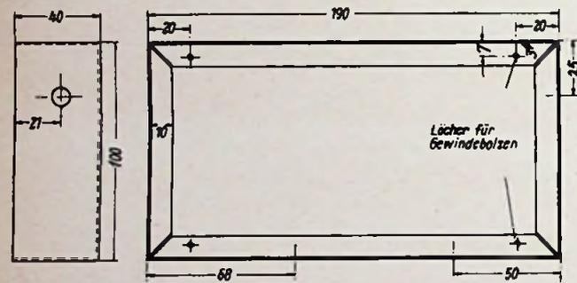
Bild 4. Maßskizze für den Rahmen des Generatorteils
