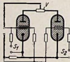
Bild 1. Schaltung zur doppelten, wechselseitigen Verriegelung. V = Verbraucher, S<sub>1</sub> = Steuerspannung 1, S<sub>2</sub> = Steuerspannung 2
