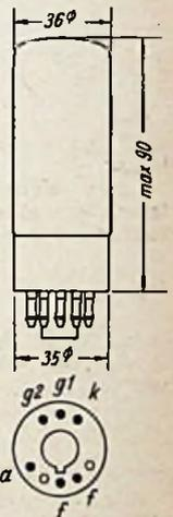
Bild 4. Abmessungen und Sockelschaltung des AEG-Thyatron AG 1041
